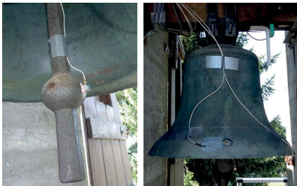
Abbildung 5: Klöppel mit Beschleunigungssensor (links) und Glocke mit DMS (rechts)
